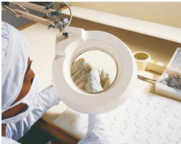
Проверка игл на наличие дефектов под освещенным и увеличивающим стеклом
