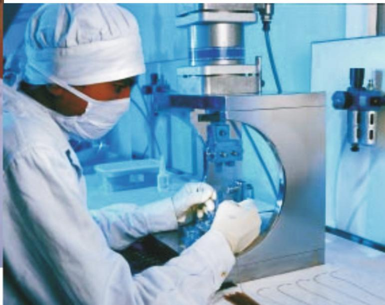
Рофилрование игл на пневматической гофрированной машине, где иглы присоединяются к шовным нитям
